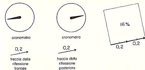
Fig. 14. Quando la lamina di vetro ha uno spessore tale da far compiere alla lancetta del cronometro che segue il fotone riflesso dalla superficie posteriore mezzo giro in più, le frecce relative alla riflessione frontale e posteriore hanno la stessa direzione e lo stesso verso e danno luogo a una freccia risultante di lunghezza 0,4, che rappresenta una probabilità del 16%.
